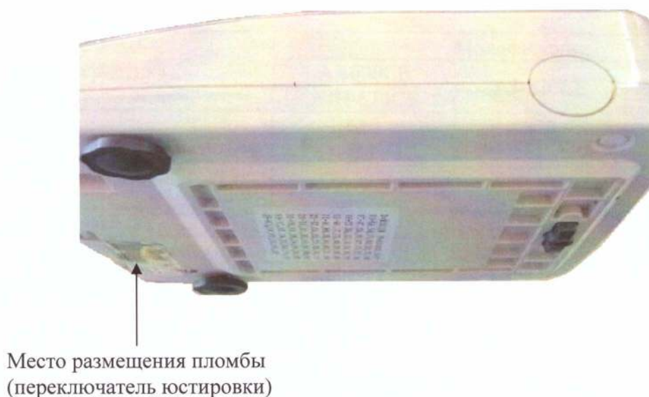
Рисунок 2 - Схема пломбировки весов от несанкционированного доступа
