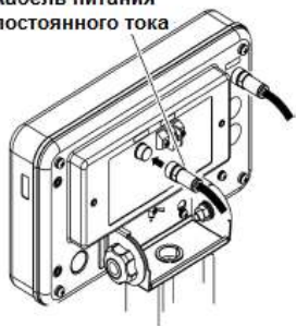
Кабель питания постоянного тока
