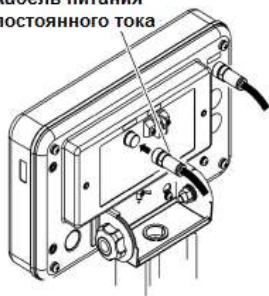
Кабель питания постоянного тока
